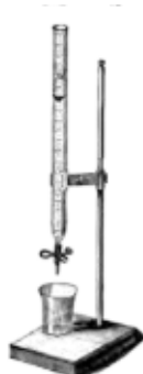
Figure 3. Burette de Mohr dans un dispositif historique de dosage par titrage.
