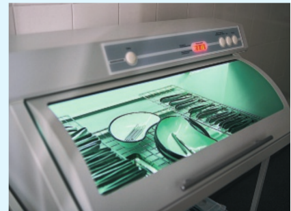
Lampe à UV-C servant à nettoyer du matériel médical.
